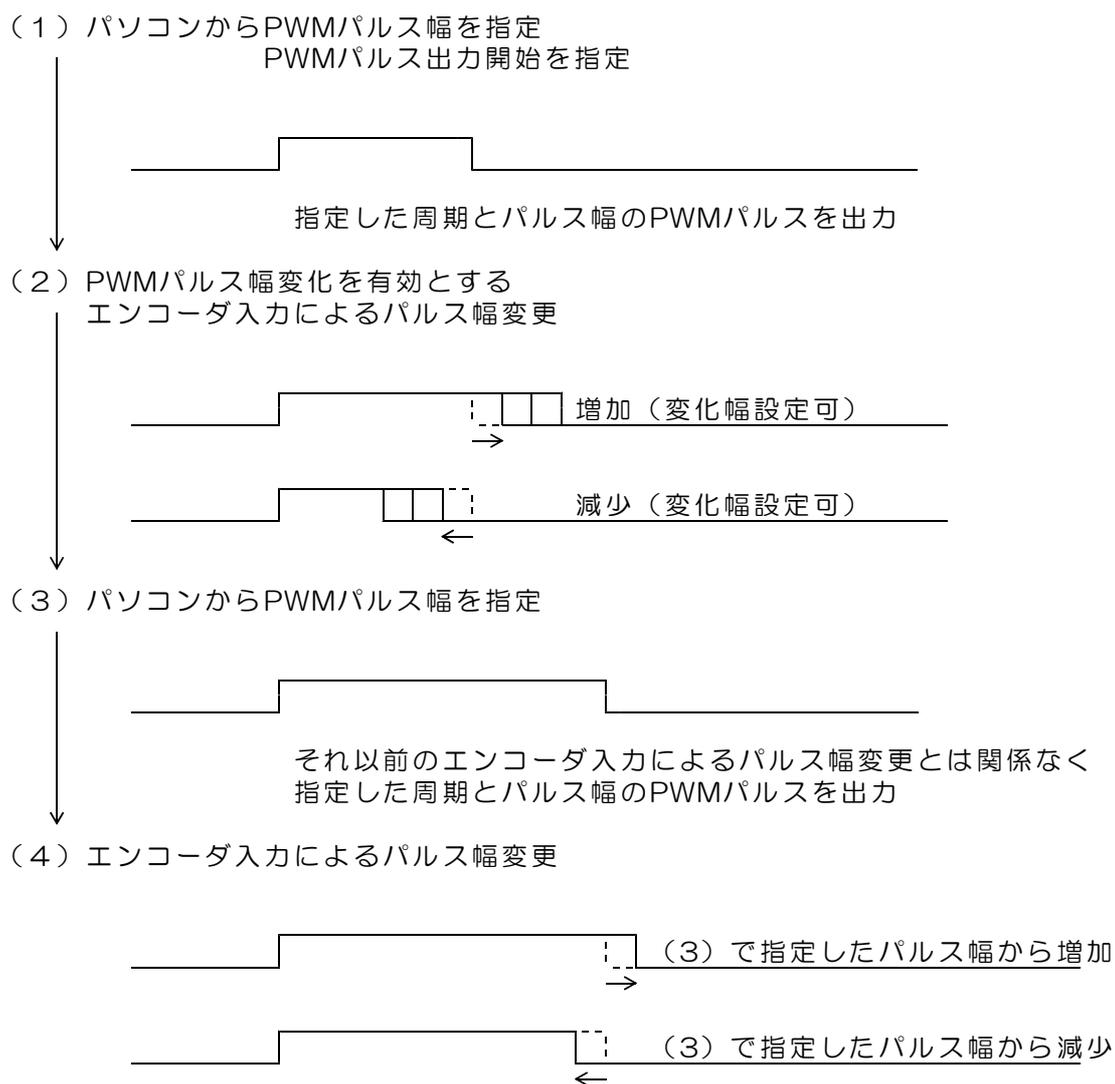
図2 エンコーダ入力によるパルス幅変更機能の動作
