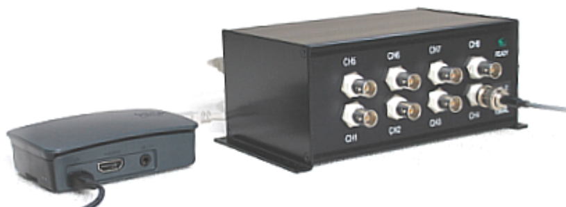
ラズベリーパイをDACsのUSBデバイスサーバーとして動作させる構成例
