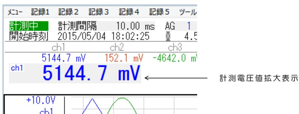
チャンネル計測電圧表示の下部位置に、計測電圧値を拡大文字にて表示します。
