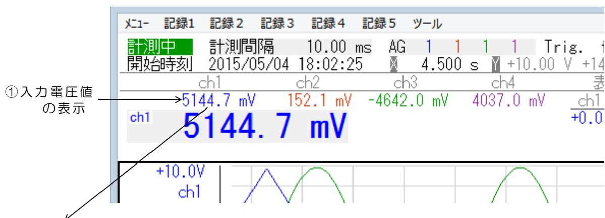
(参考) 計測ユニット内部の高速積算機能と計測ソフトウェアの特殊フィルタリング処理により、表示桁最下位までをリニアに表示します。
