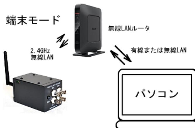
(ご参考3) 端末モードに設定後でも、設定した接続先がないときは、計測ユニットの電源投入より約15秒後に、APモードに移行します。
