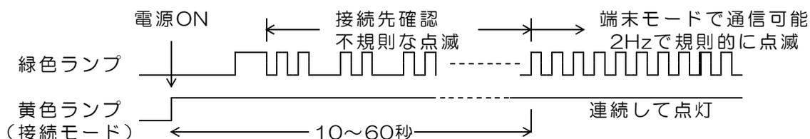
(ご参考) 端末モードに接続後、無線LANルータの電源が切れるなどで、ネットワークの切断があると、計測ユニットの電源がONの間は、16秒間隔で、端末モードの接続試行を繰り返しますので、ネットワークが回復すると、再び、端末モードで動作します。
