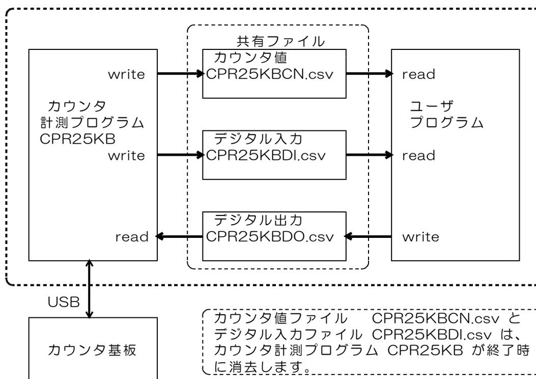
カウンタ計測プログラム CPR25KB は、おおむね 0.1秒間隔で、（1）カウンタ値ファイル CPR25KBCN.csv、（2）デジタル入力ファイル CPR25KBDI.csv にデータを書込みます。また、同じ間隔で（3）デジタル出力ファイル CPR25KBDO.csv を読取ります。
