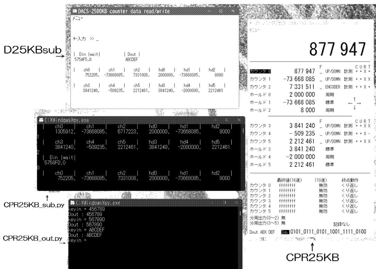
この3種類の外部連携サンプルプログラムは、フォルダ dacs2500KB\_CNT に、カウンタ計測ソフト実行ファイル CPR25KB.exe と共に、ソースファイル付きで収納しています。詳細な動作仕様は、各ソースファイルの注釈をご覧ください。
