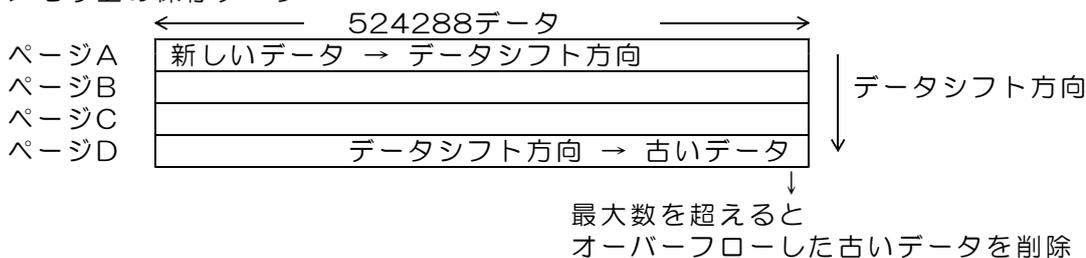
最大ページ数を指定して、指定ページ数になったときに自動停止することもできます。最大サンプリング数に次の負数を指定すると、指定ページ数を超えた時点で、計測は自動停止します。ページ指定ではページ単位でのサンプリング数指定となります。
