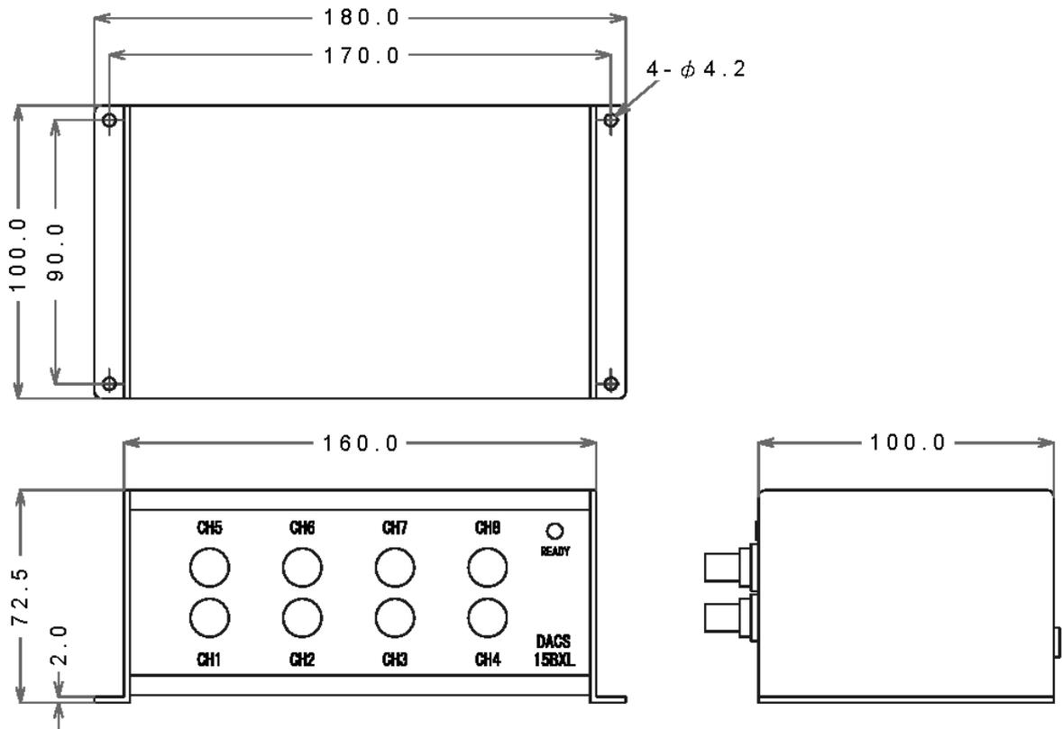
図1. 4 計測ユニット 15BXL 固定用L側板タイプ 外形図
