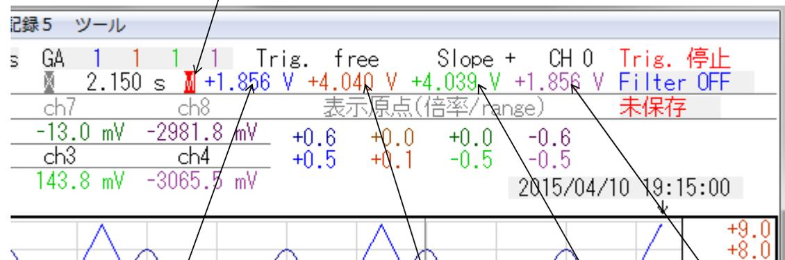
マウスX位置のCH1, 5 計測電圧 CH2, 6 CH3, 7 CH4, 8
