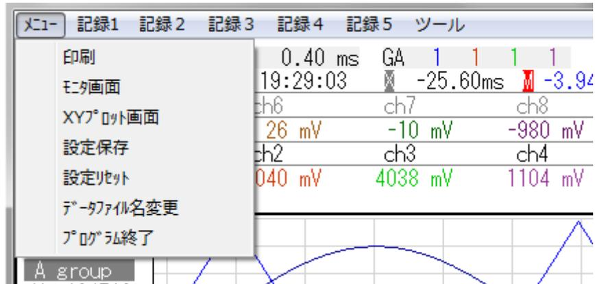
「XYプロット画面」をクリックすると「XY表示」モードになり、計測を開始すると、XY表示にて画面描画します。「モニタ画面」をクリックするとモニタ表示モードに戻ります。表示を切換えると、それまでの表示画面を消去します。
