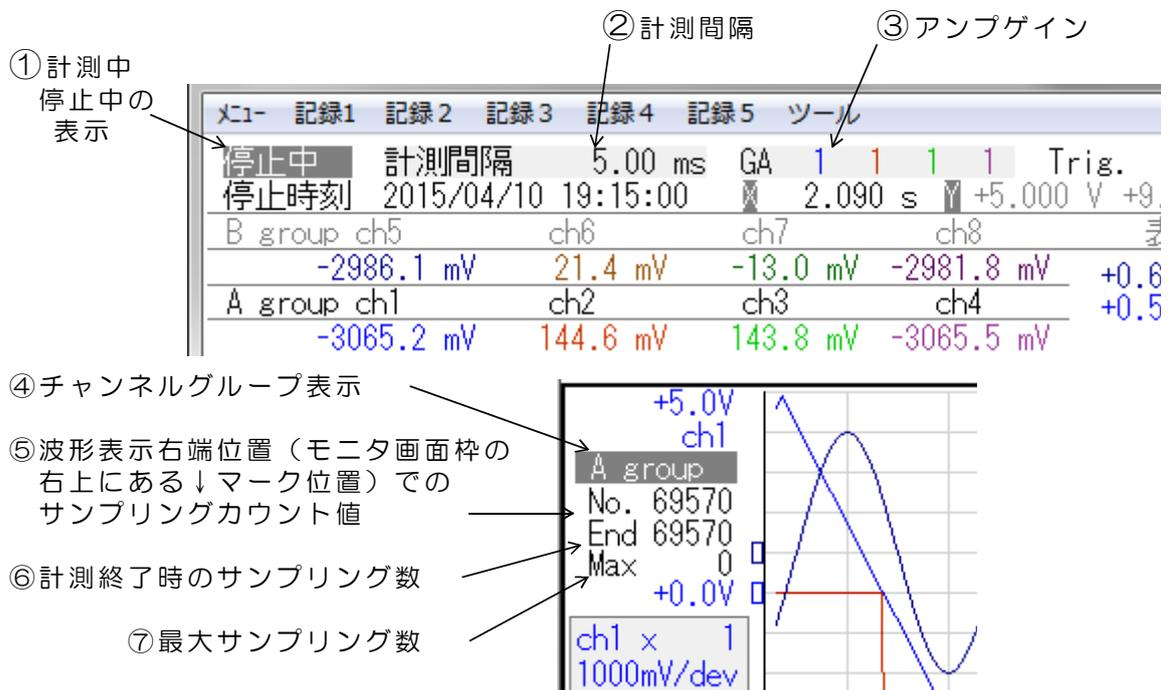
上図の「最大サンプリング数」の部分 **Max** を、マウス左クリックすると、画面2行目の左端に 最大データ数 = と表示がでますので、数字キー、BSキーを使用して、最大サンプリング数を入力します。数値入力後、エンターキーを押して、最大データ数を確定します。ESCキーを押すと入力をキャンセルできます。最大サンプリング数として指定できるのは、格納ページ1ページ分の 524288 です。格納ページについては、後述をご覧ください。
